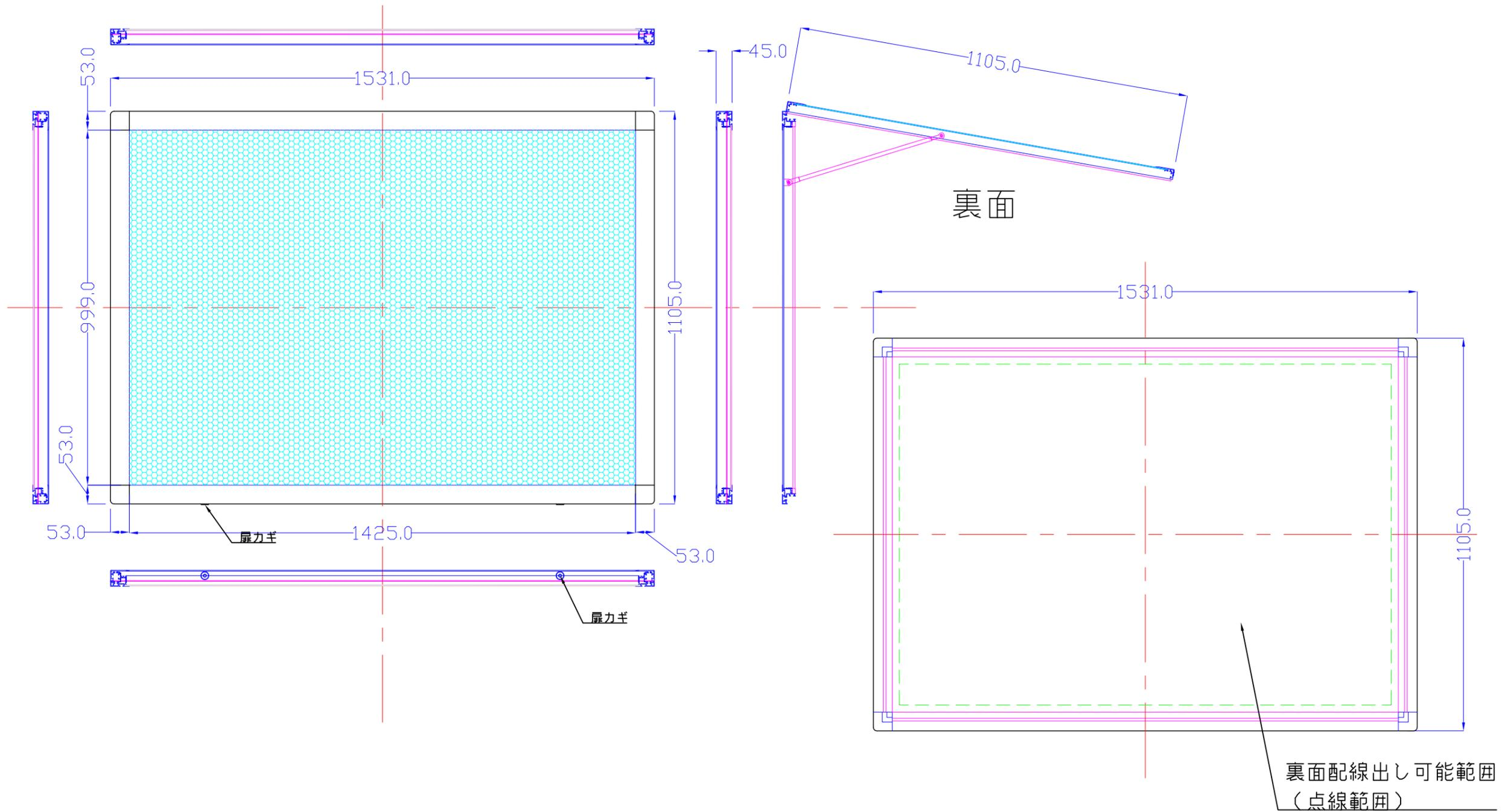
\* 電源配線は裏面（点線内）およびフレーム側面（基本下側）となります。
