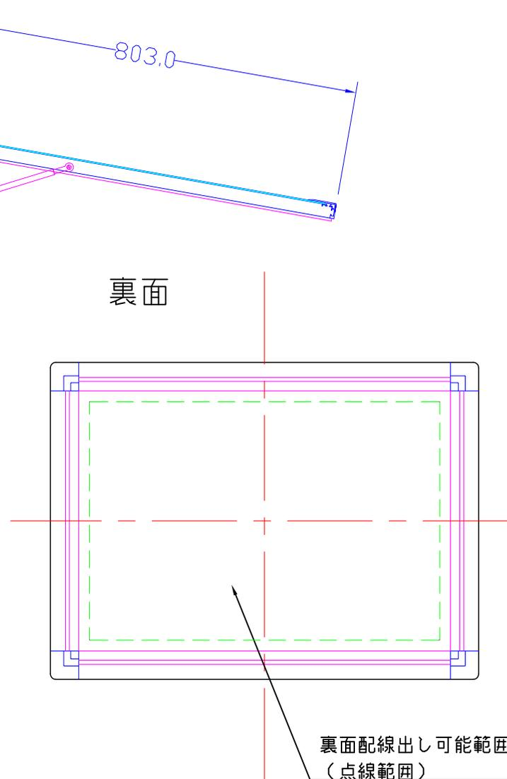
\* 電源配線は裏面 (点線内) およびフレーム側面 (基本下側) となります。
